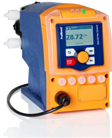
**DULCOFLEX DFXa dosifica medios gasificantes, viscosos, abrasivos o sensibles al cizallamiento y establece nuevos estándares en la dosificación. Con esta bomba peristáltica se garantiza una dosificación lineal y repetible ( $\pm 1\%$ ) en todas las condiciones de proceso. La operación de cambio de manguera es sencilla.**
