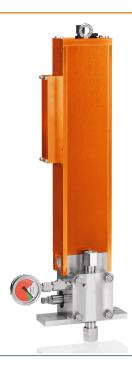
La ORLITA Evolution mikro es una bomba innovadora para la dosificación de cantidades muy reducidas a alta presión. Esta bomba dosificadora de membrana hidráulica es la primera de su clase con accionamiento directo lineal regulado electrónicamente. El accionamiento presenta pocos elementos funcionales mecánicos, por lo que está prácticamente exento de mantenimiento.
