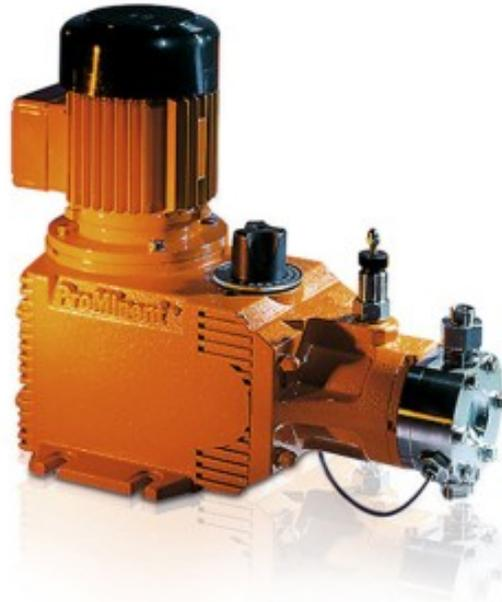
La HYDRO API 675 es una bomba dosificadora de membrana hidráulica muy robusta que cumple con los requisitos de seguridad más estrictos y está diseñada según la norma API 675. De ello se encargan, por ejemplo, la membrana multicapa de PTFE con control de membrana, el Full-motion Drive y la válvula de purga de aire automática. Su diseño modular le confiere una gran flexibilidad en el campo de aplicación.
